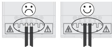
**NOTA IMPORTANTE SOBRE CONEXIONES:** Antes de conectar ningún cable en entrada/salida, la cubierta de protección debe estar correctamente instalada. La parte metálica del cable o del contacto debe estar completamente insertada en el terminal.
