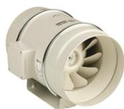
Ventiladores helicocentrífugos de bajo perfil. El cuerpo-motor es desmontable sin necesidad de tocar los conductos. Fabricados en material plástico (modelos 160 a 800) o en chapa de acero galvanizada protegida con pintura epoxi-poliéster anticorrosiva (modelos 1000 a 6000).
