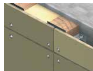
Fibrocemento sobre madera.
